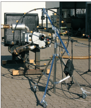
Schallquellenlokalisierung an einem Schraubenkompressor mit Carbonring-Mikrofonarray
