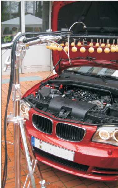
Schallquellenlokalisierung im Motorraum eines Pkw
