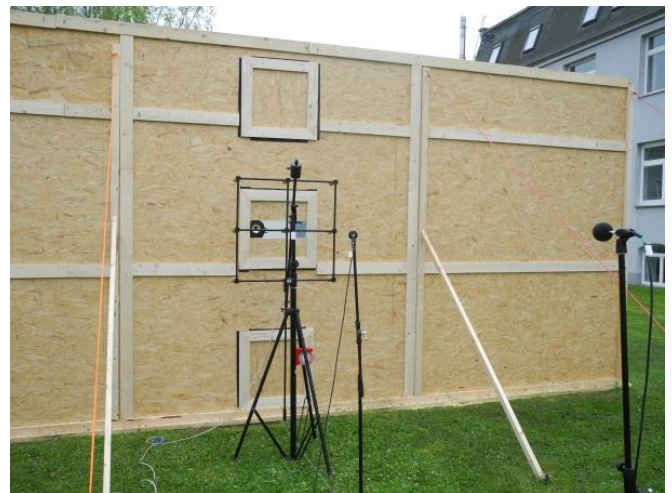
Abbildung 5: Aufbau für Messung an Test-Lsw mit geometrisch exakten Leckagen
