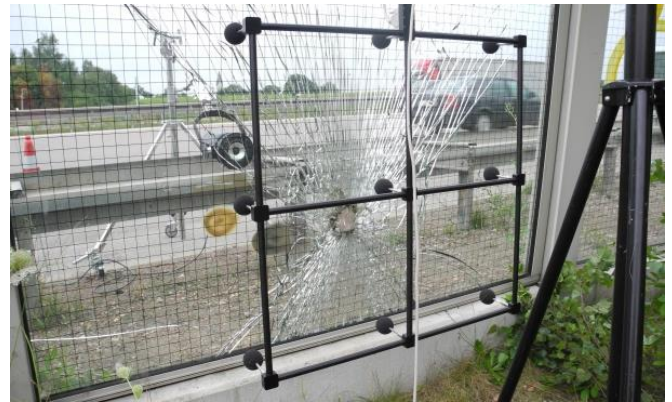
Abbildung 9: Versuchsaufbau zur messtechnischen Bestimmung der Schalldämmung einer beschädigten Lsw in situ
