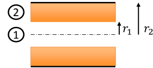
Abbildung 5: Schematischer Aufbau eines Absorptionsschalldämpfers. Im Bereich 0 < r \leq r_1 befindet sich Luft und im Bereich r_1 < r \leq r_2 Absorptionsmaterial.
