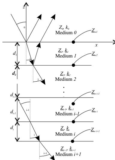
Bild 1: Schalleinfall ebener Wellen auf geschichtete homogene Absorbermedien.
