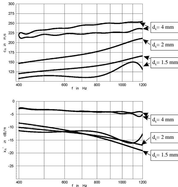
Bild 3: Ausbreitungsgeschwindigkeit  $c_A$  und Dämpfung  $k_A''$  innerhalb von Hohlkugelstrukturen als Funktion der Frequenz gemessen mit Hilfe der „Übertragungsmatrixmethode“; Parameter  $d_k$  Kugeldurchmesser.
