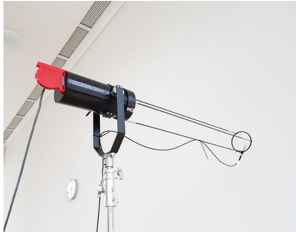
Messung des Schallabsorptionsgrads an einem Wandabsorber im Raum in situ mit AcoustiAdrienne
