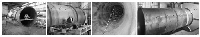
**Abbildung 6:** Versuchsaufbau zur Messung des Durchgangsdämpfungsmaßes  $D_{TL}$  mittels des Two-Load-Verfahrens und  $D_{ts}$  gemäß [7] sowie der Luft- und Körperschallenergien vor und hinter dem Schiffsschalldämpfer bei Luft- und Körperschallanregung mittels Lautsprecher und Shaker
