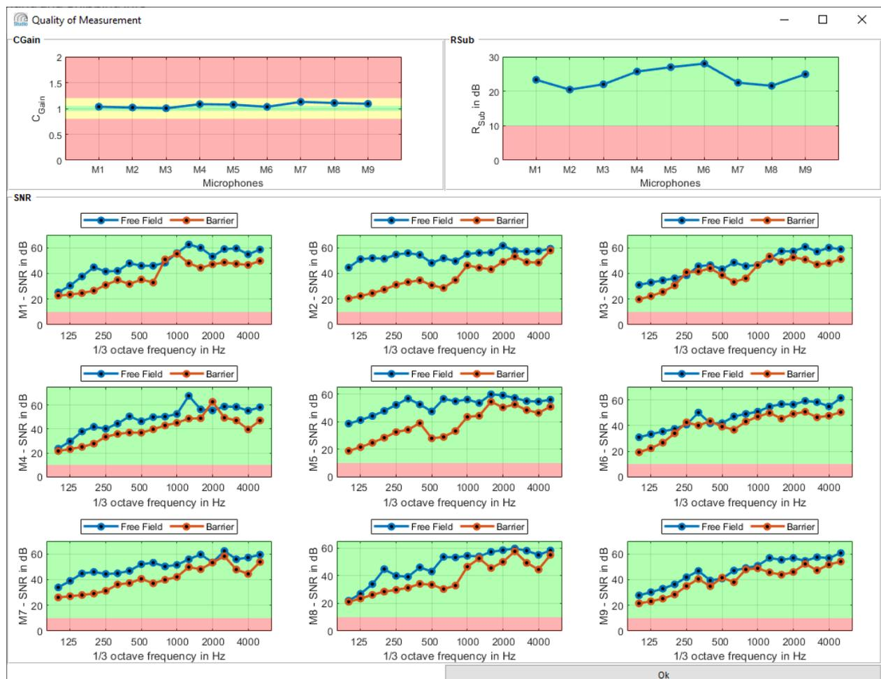
Abbildung 4.2: Kontrollfenster zur Bewertung der Qualität der Messung
