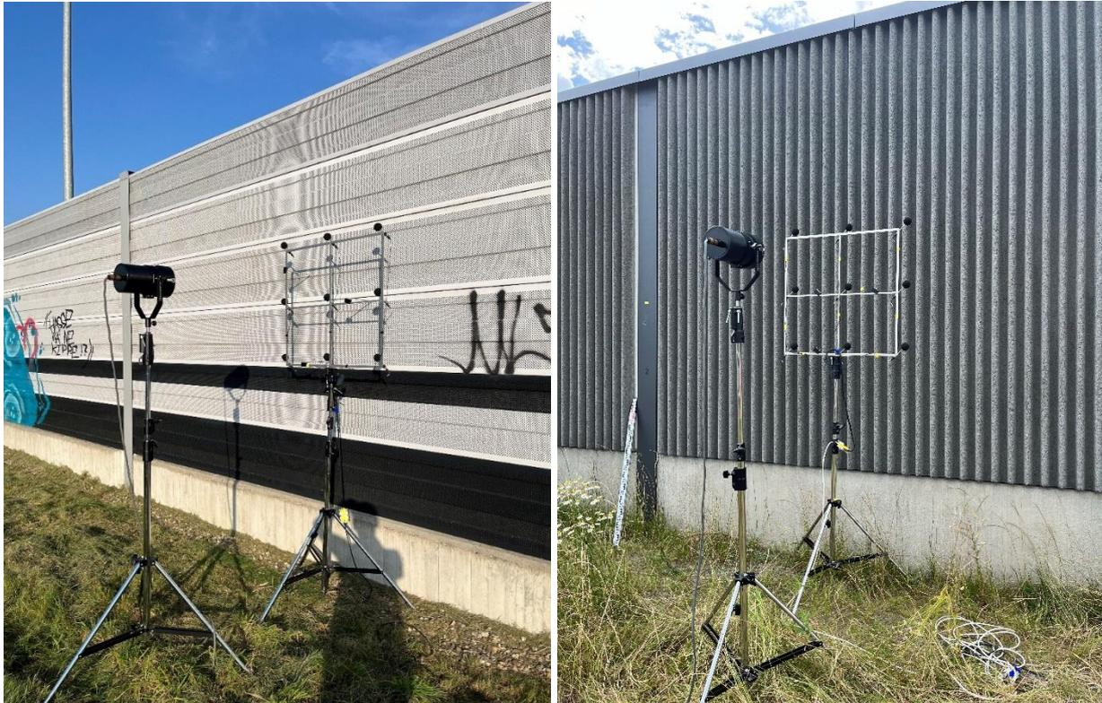
Abbildung 2.3: Beispielhafte Aufbauten des Messsystems AcoustiAdrienne – Modul Schallreflexion in situ an Lärmschutzwänden
