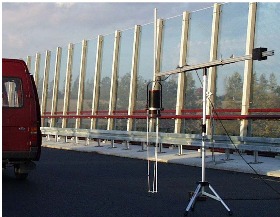
Bild 6: Messvorrichtung zur winkelabhängigen Bestimmung der Wandimpedanz der Fahrbahnoberfläche.
