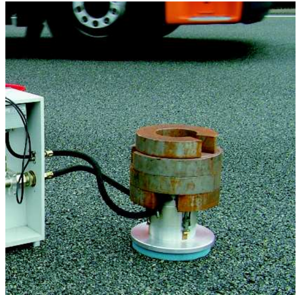
Bild 1: Messaufsatz zur Bestimmung des effektiven spezifischen Strömungswiderstands R'_s .
